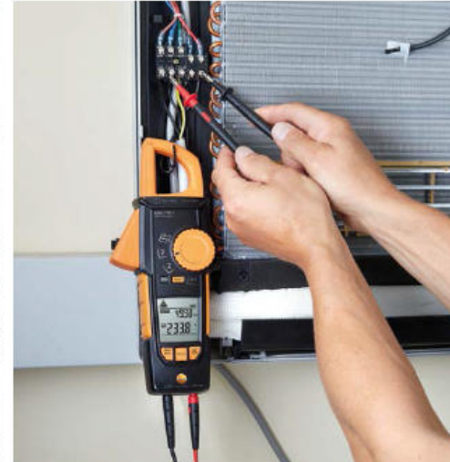
Spannungsmessung an einem Klimagerät mit testo 770 .
