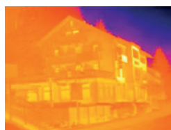
Wärmebild ohne testo ScaleAssist
